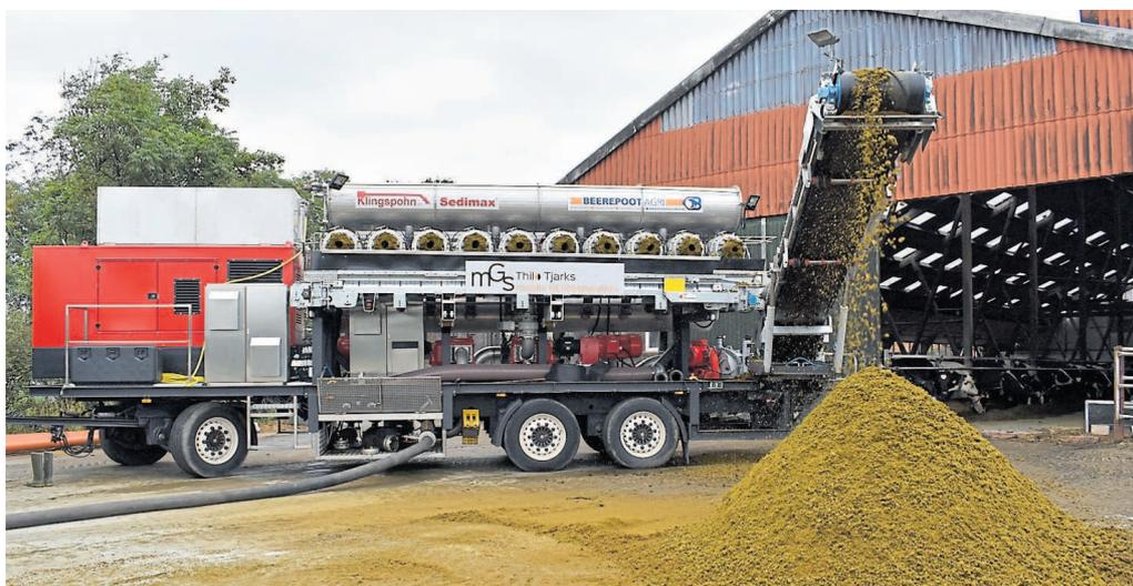
Die mobile Gülleseparationsanlage auf einem Hof in Tengshausen. Durch zehn Pressschneckenseparatoren werden Schweinegülle, Rindergülle und Gärreste separiert. BILDER: FRANK BRÜLING
